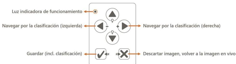
Fig. 50: Funciones de panel de la medicam 1000 para imágenes microscópicas.
