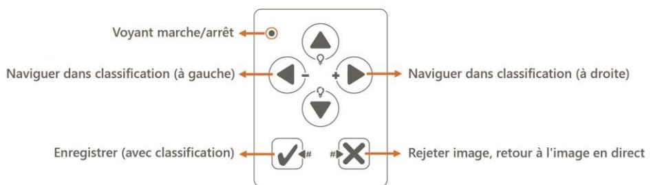
Fig. 50 : Fonctions du panneau de la *medicam 1000* utilisées pour la prise de photos microscopiques
