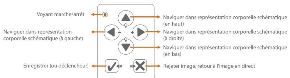
Fig. 42 : fonctions du panneau de la medicam 1000 utilisées pour la prise de photos d'ensemble
