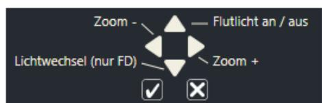
Aktivieren oder deaktivieren Sie die Anzeige der medicam Tastenbelegungen in der Software.
