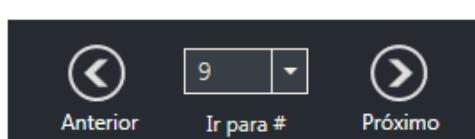
Os botões *Anterior* e *Próximo* permitem que você pule de um marcador para o próximo. Você pode pular diretamente para a posição desejada do marcador usando o botão *Ir para #*.
