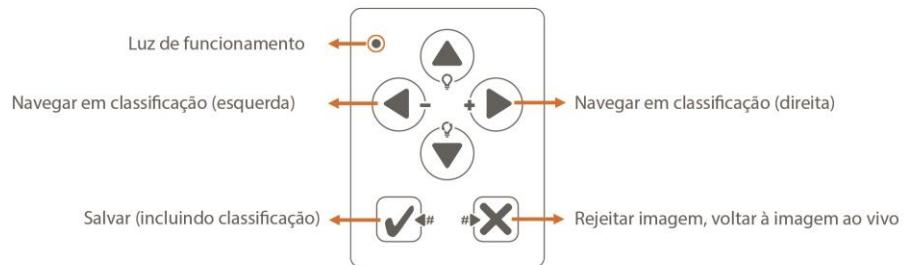
Fig. 50: Funções de painel da medicam 1000 durante a captura de imagens microscópicas.
