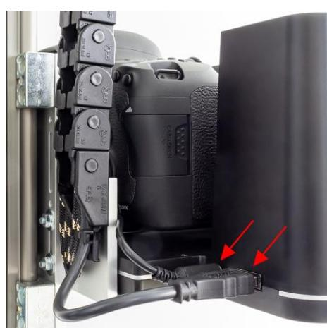
Abb. 12: Kabelverbindungen von PolFlash XE und Kamera am ATBM Tower (Ansichten von links und rechts)
