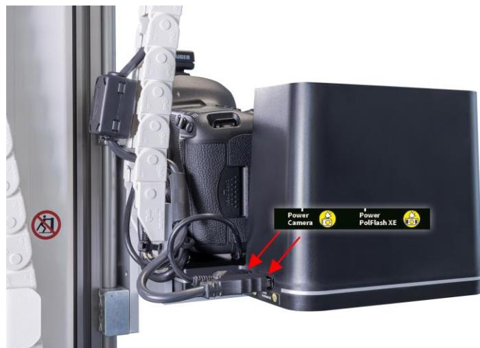
Abb. 9: Kabelverbindungen von PolFlash XE DX2 und Kamera am ATBM Tower (Ansicht von rechts)
