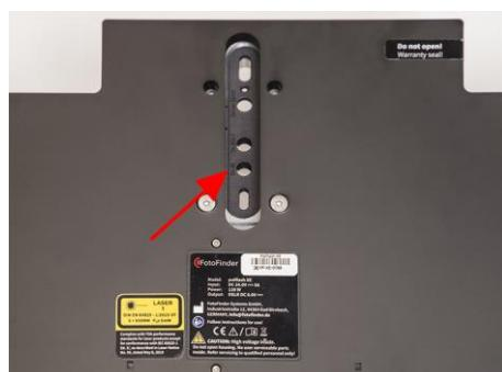
5. Schrauben Sie die Kamera von unten durch das entsprechende Schraubloch der Positionierungshilfe an. Benutzen Sie dazu das zuvor zusammengesteckte Montagematerial. Beachten Sie bitte, dass Sie das Stromversorgungskabel der Kamera nach hinten führen und nicht unter oder vor der Kamera einklemmen.
