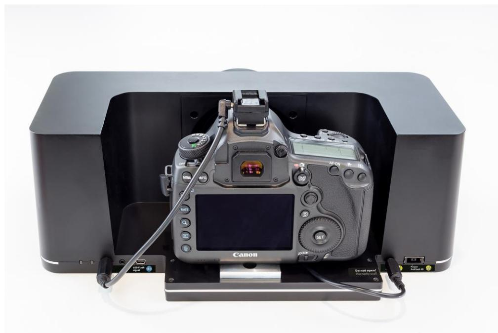
Abb. 10: Fertig montierte Kamera am PolFlash XE
