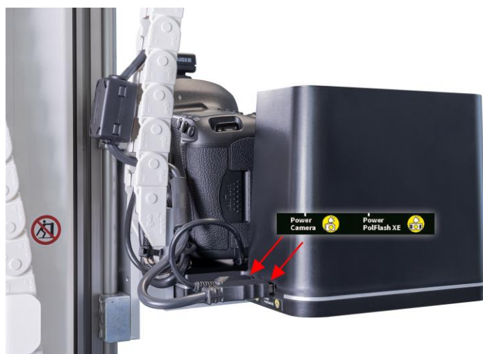
Fig. 9: Conexiones de cable del Polflash XE DX2 y la cámara en la torre ATBM (vista desde la derecha)
