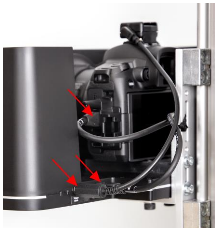
Fig. 12: Conexiones de cable del PoIFlash XE y la cámara en la ATBM Tower (vistas desde la izquierda y la derecha)
