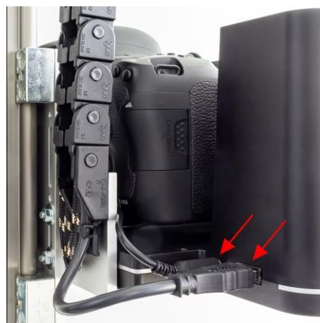
Fig. 12: raccords de câble du Polflash XE et de l'appareil photo sur la tour ATBM (vues de gauche et de droite)
