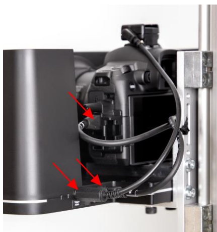
Fig. 12: raccords de câble du Polflash XE et de l'appareil photo sur la tour ATBM (vues de gauche et de droite)
