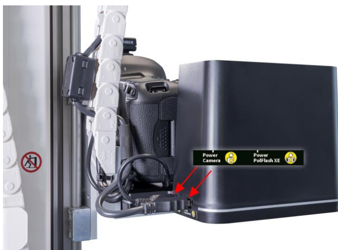
Fig. 9: raccords de câble du Polflash XE DX2 et de l'appareil photo sur la tour ATBM (vue de droite)
