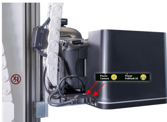
Fig. 9: collegamento dei cavi di PolFlash XE DX2 e della fotocamera all'ATBM Tower (vista da destra)
