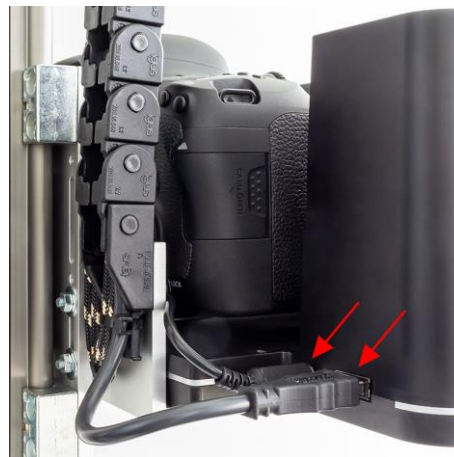
Fig. 12: collegamento dei cavi di PolFlash XE e delle fotocamera all'ATBM Tower (vista da sinistra e da destra)
