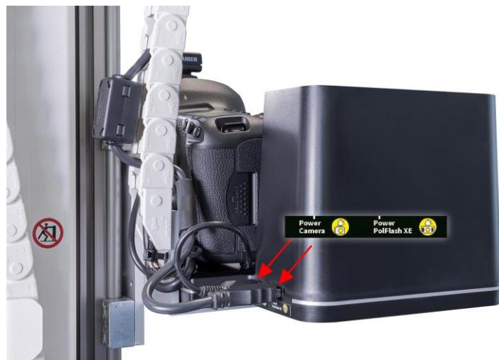
Fig. 9: Ligações de cabos de PolFlash XE DX2 e câmera na Torre ATBM (vista da direita)
