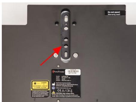
5. Aparafuse a câmera por cima através do respectivo furo de rosca dos auxiliares de posicionamento. Para o procedimento, utilize o material de montagem previamente montado. Certifique-se de que você conduz o cabo de alimentação da câmera para trás e não o aperte sob ou à frente da câmera.
