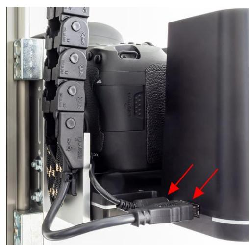
Fig. 12: Ligações de cabos de PolFlash XE e câmera na Torre ATBM (vistas da esquerda e da direita)
