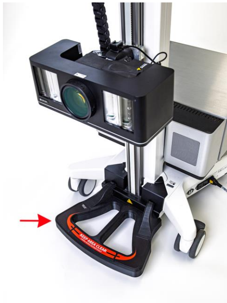
Abb. 5: ATBM master mit Bumper
