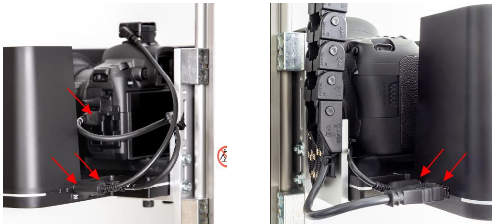
Abb. 13: Kabelverbindungen von PoIFlash XE und Kamera am ATBM Tower (Ansichten von links und rechts)
