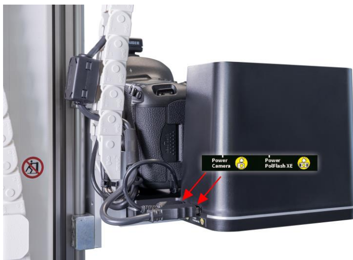
Abb. 10: Kabelverbindungen von PolFlash XE DX2 und Kamera am ATBM Tower (Ansicht von rechts)
