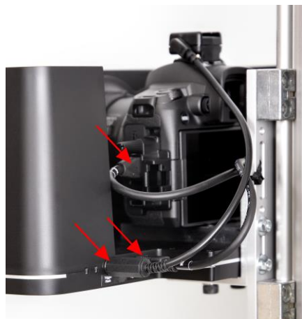
Fig. 13: Conexiones de cable del PoIFlash XE y la cámara en la ATBM Tower (vistas desde la izquierda y la derecha)
