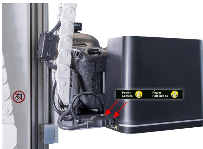
Fig. 10: Conexiones de cable del Polflash XE DX2 y la cámara en la torre ATBM (vista desde la derecha)
