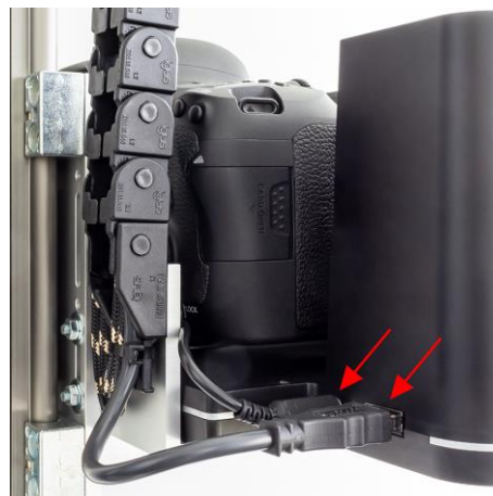
Fig. 13: Conexiones de cable del PoIFlash XE y la cámara en la ATBM Tower (vistas desde la izquierda y la derecha)
