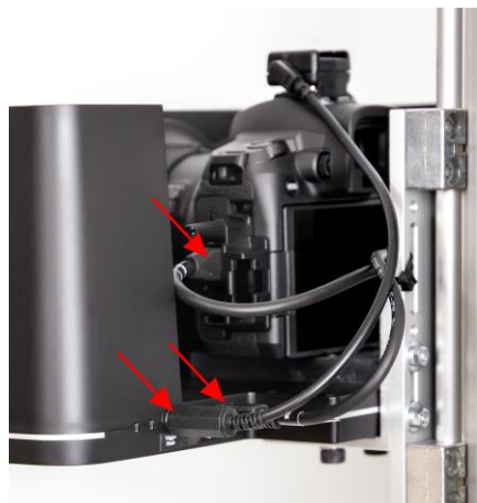
Fig. 13: raccords de câble du Polflash XE et de l'appareil photo sur la tour ATBM (vues de gauche et de droite)
