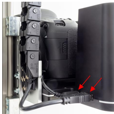
Fig. 13: raccords de câble du Polflash XE et de l'appareil photo sur la tour ATBM (vues de gauche et de droite)
