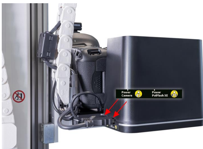
Fig. 10 : raccords de câble du Polflash XE DX2 et de l'appareil photo sur la tour ATBM (vue de droite)
