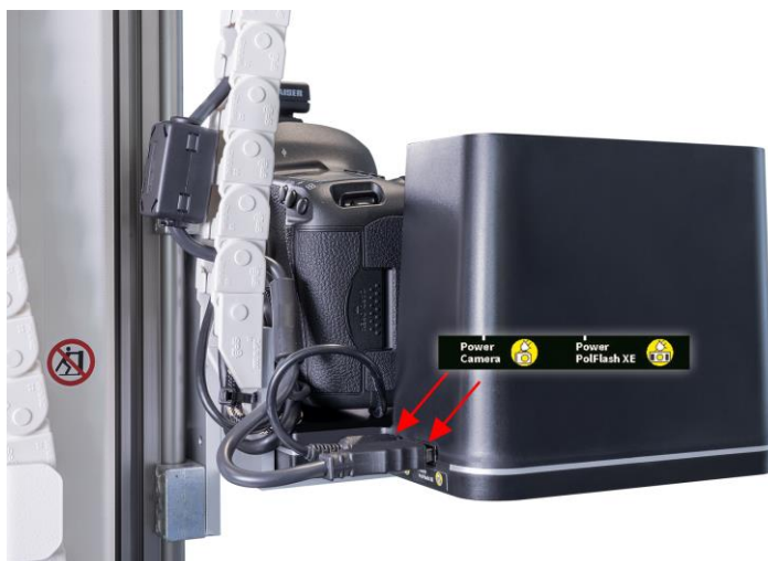
Fig. 10: collegamento dei cavi di PolFlash XE DX2 e della fotocamera all'ATBM Tower (vista da destra)
