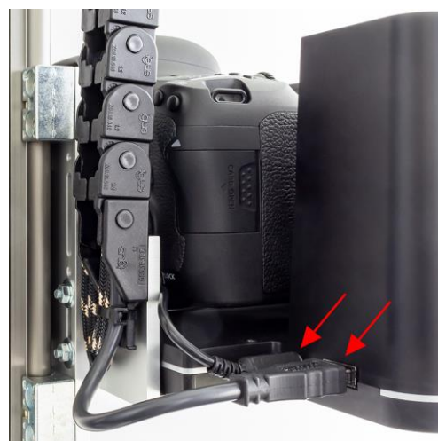
Fig. 13: Ligações de cabos de PolFlash XE e câmera na Torre ATBM (vistas da esquerda e da direita)
