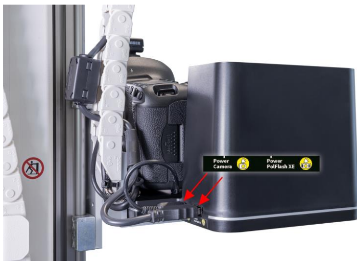
Fig. 10: Ligações de cabos de PolFlash XE DX2 e câmera na Torre ATBM (vista da direita)
