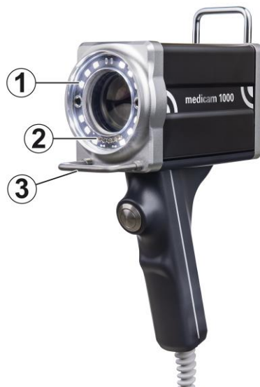
Abb. 3: Für Übersichtsaufnahmen: medicam 1000 ohne Vorsatzobjektiv
