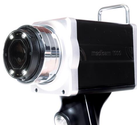
Fig. 9: Vista del medicam 1000 con D-Scope IV con la tapa del accesorio extraída y la luz LED activa para capturas no polarizadas.
