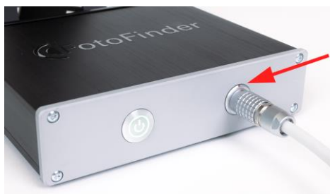
Fig. 14: Conector redondo push-pull con cable medicam en la Docking Station
