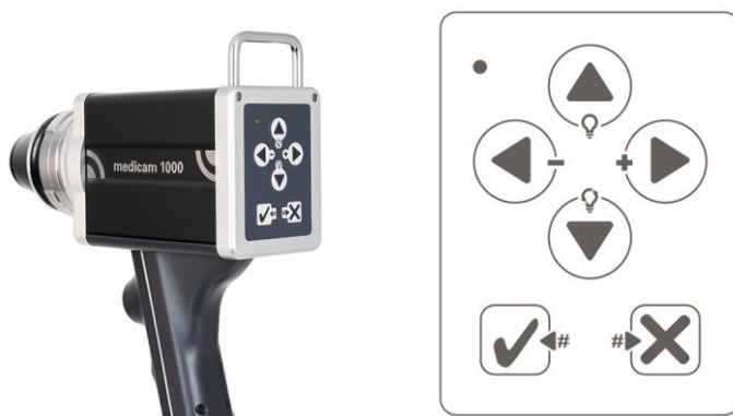
Fig. 17: Lado trasero y panel de control de la medicam 1000
