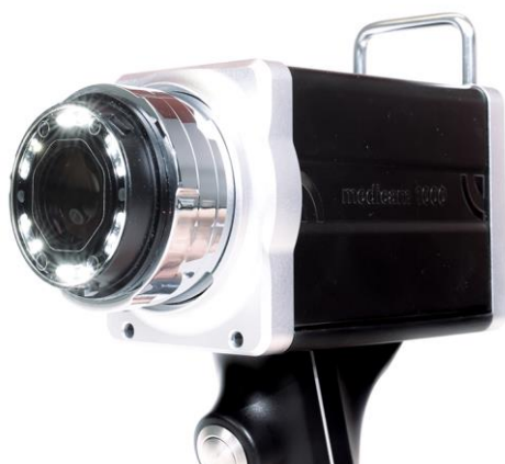
Fig. 8 : vue de la medicam 1000 avec D-Scope IV sans embout et lumière LED active pour les photos polarisées.
