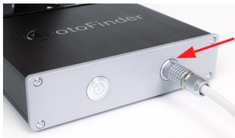
Fig. 14: Prise ronde « push-pull » avec câble medicam sur la Docking Station
