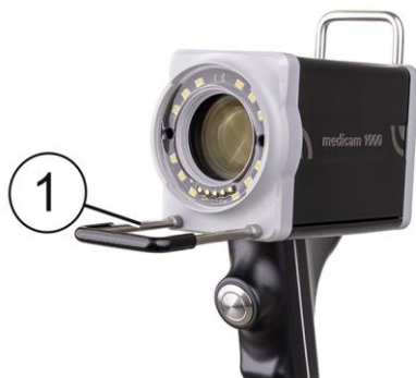
Fig. 5: medicam 1000 con distanziatore (1), nell'immagine: da 63 mm
