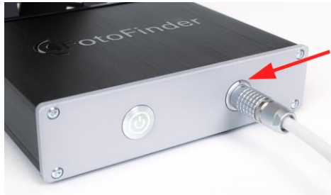
Fig. 14: Attacco per connettore circolare push-pull con cavo medicam sulla Docking Station
