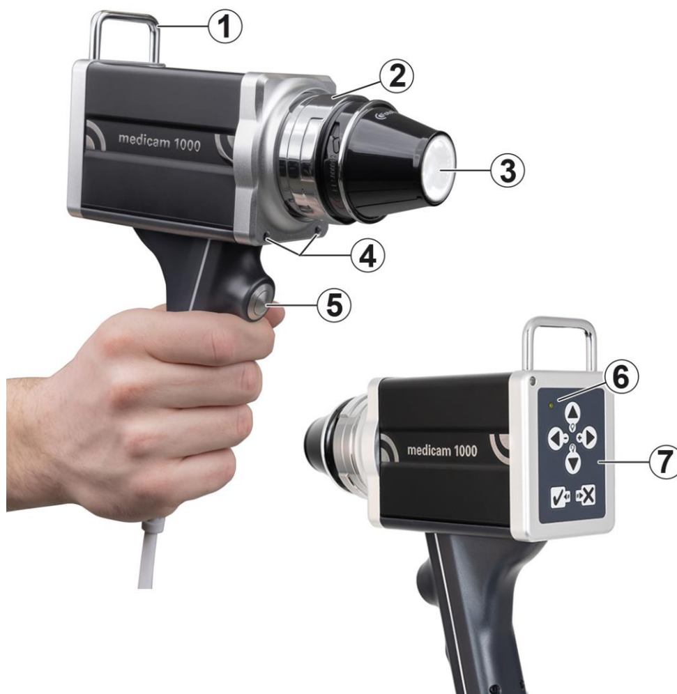
Fig. 2: medicam 1000 com lente acessória D-Scope IV (para imagens dermatoscópicas)
