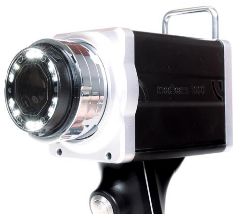
Fig. 8: Vista medicam 1000 com D-Scope IV com tampa acessória removida e luz LED ativa para imagens polarizadas.
