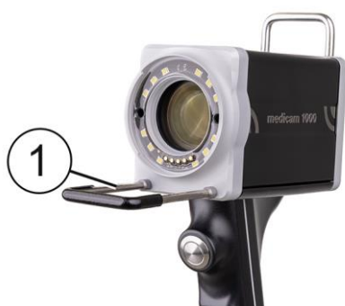
Fig. 5: medicam 1000 con distanciador (1), aquí 63 mm
