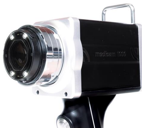
Fig. 9 : vue de la medicam 1000 avec D-Scope IV sans embout et lumière LED active pour les photos non polarisées.
