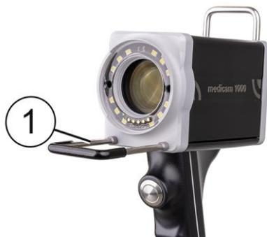
Fig. 5: medicam 1000 con distanziatore (1), nell'immagine: da 63 mm
