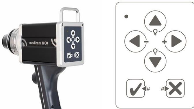
Fig. 17: Painel traseiro e de controle da medicam 1000
