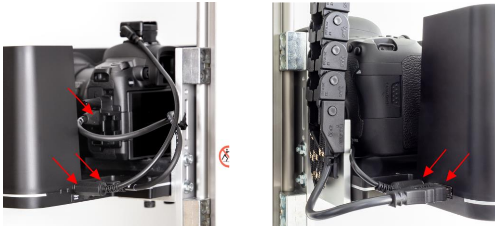
Фиг.8: Кабелни връзки на PolFlash XE и камерата към кулата на АТВМ (гледано отляво и отдясно)
