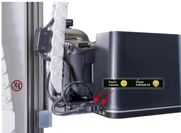
Фиг. 6: Кабелни връзки на PolFlash XE DX2 и камерата към АТВМ кулата (изглед отдясно)
