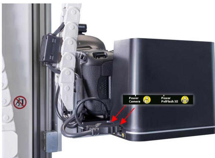
Obr. 2: Kabelové připojení PoIFlash XE a kamery k věži ATBM (pohled zprava)
