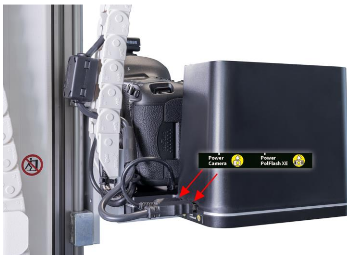
Εικ. 6: Συνδέσεις καλωδίων του PolFlash XE DX2 και της φωτογραφικής μηχανής στον πύργο ATBM (όπως φαίνονται από τα δεξιά)
