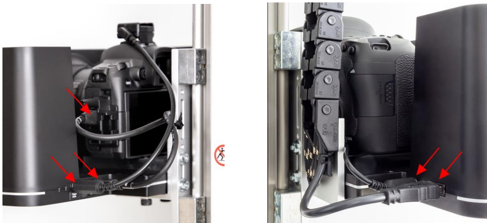
Εικ. 8: Συνδέσεις καλωδίων του PoIFlash XE και της φωτογραφικής μηχανής στον πύργο ATBM (όπως φαίνονται από τα αριστερά και τα δεξιά)
