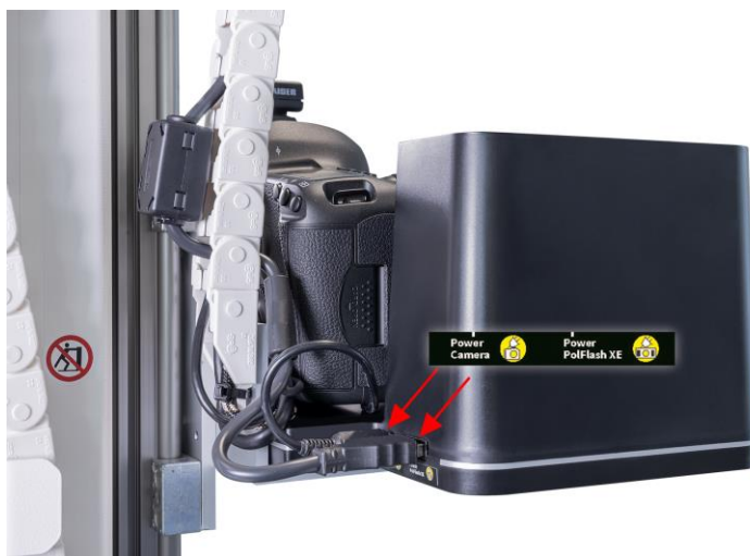
Ábra 2 : A PolFlash XE DX2 és a kamera kábelcsatlakozásai az ATBM toronyhoz (jobbról nézve)
