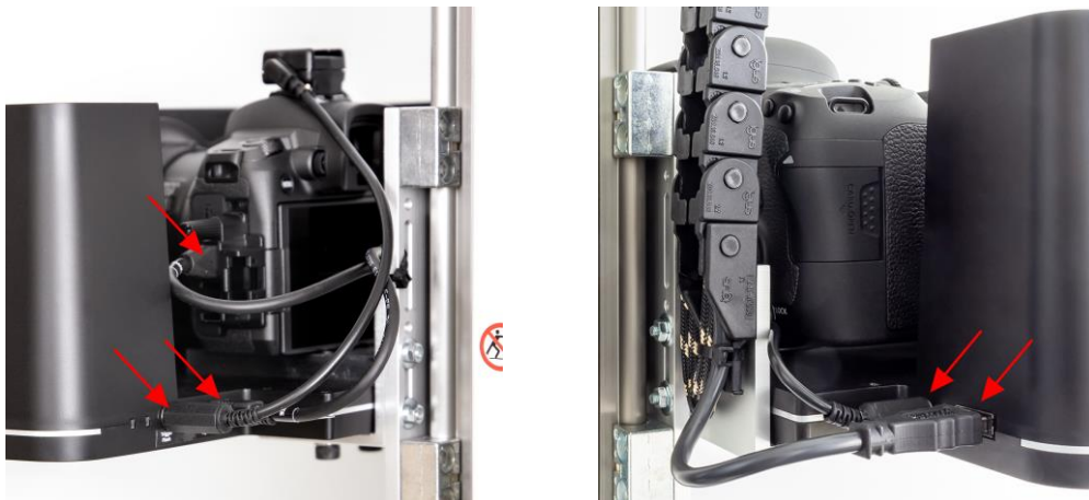
Ábra5 : A PolFlash XE és a kamera kábelcsatlakozásai az ATBM toronyhoz (balról és jobbról nézve)
