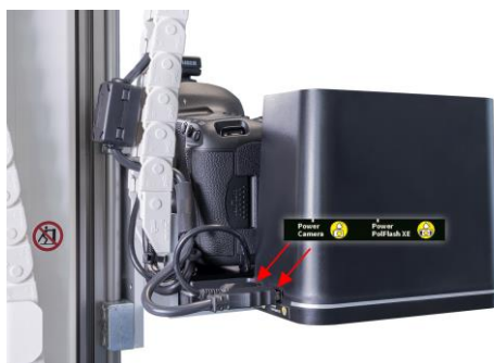
Pav. 2: „PolFlash XE DX2“ ir kameros kabelių jungtys su ATBM bokštu (žiūrint iš dešinės)
