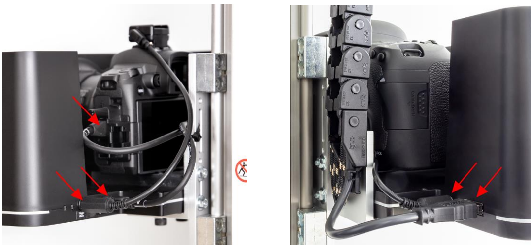
Pav. 5: „PolFlash XE“ ir kameros kabelių jungtys su ATBM bokštu (žiūrint iš kairės ir dešinės)
