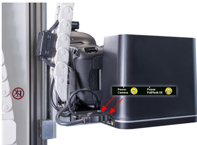
Bilde 2: Kabeltilkoblinger for PolFlash XE DX2 og kamera til ATBM-tårn (sett fra høyre)
