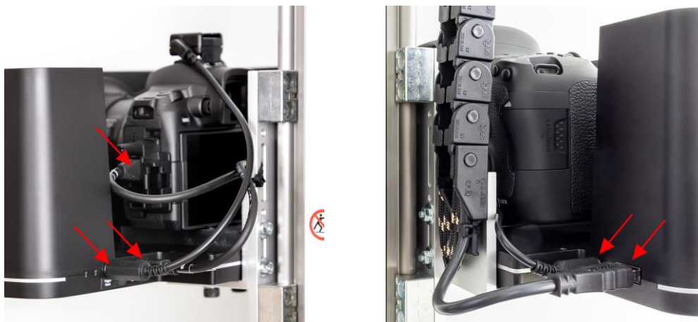
Obr. 5: Káblové pripojenia PoIFlash XE a fotoaparátu k ATBM veži (pohľad zľava a sprava)
