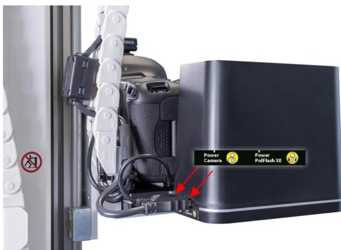
Obr. 2: Káblové pripojenia PolFlash XE DX2 a fotoaparátu k veži ATBM (pohľad sprava)
