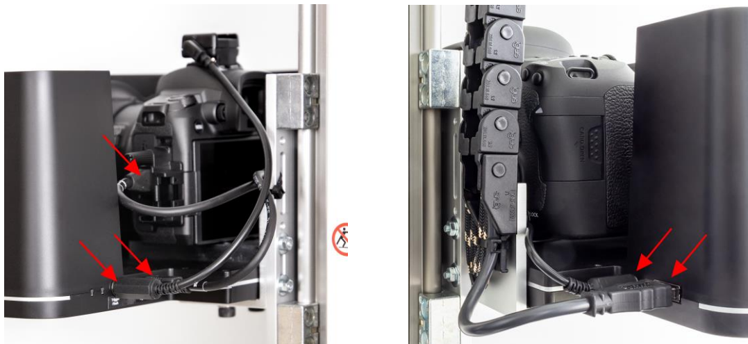
Fig. 5: Kabelanslutningar på PoIFlash XE och kameran till ATBM Tower (sett från vänster respektive höger)
