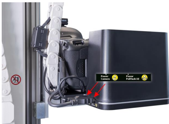
Fig. 2: Kabelanslutningar på PoIFlash XE DX2 och kameran till ATBM Tower (sett från höger)
