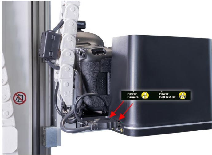
Şekil 2: PolFlash XE DX2 ve kameranın ATBM Kulesine kablo bağlantıları (sağdan görünüm)
