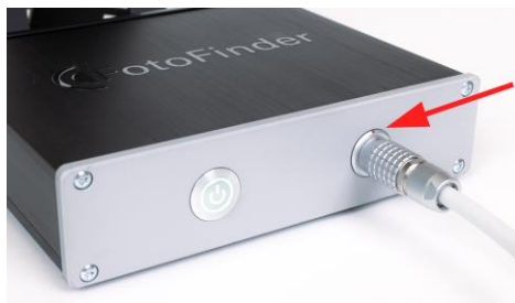
Фиг.3: Кръгло щепселно пушпулно съединение с кабела на medicam на докинг станцията
