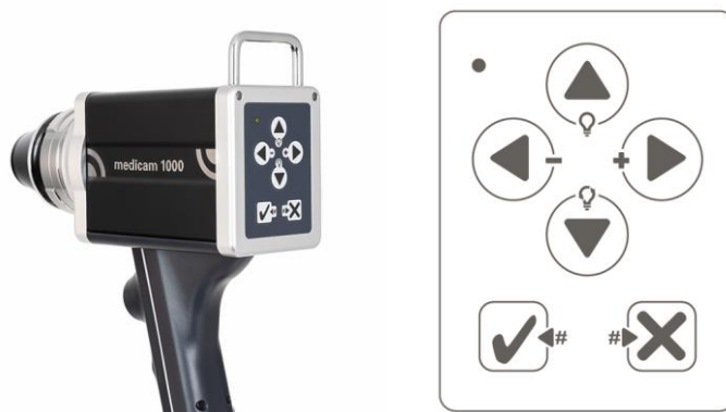
Obr. 6: Zadní a ovládací panel medicam 1000
