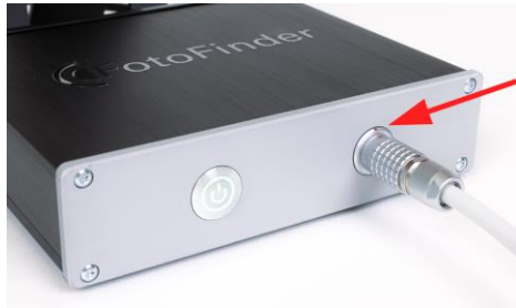
Εικ. 6: Σύνδεση στρογγυλού παλινδρομικού φιν με το καλώδιο του medicam στον σταθμό τοποθέτησης
