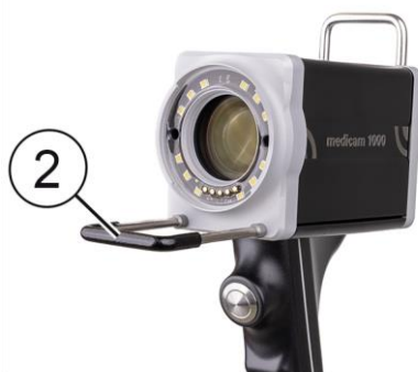
Εικ. 1: Κλιπ για ιατρικό αποστάτη medicam (2)
