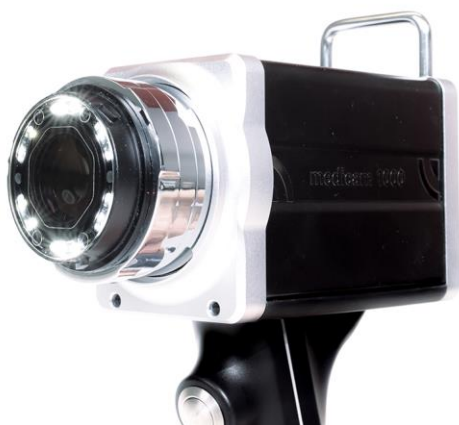
1. ábra : A medicam 1000 D-Scope IV-vel, eltávolított elülső kupakkal és aktív LED-es világítással, polarizált képekhez.
