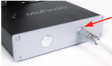
Pav. 4: Stumiamo apvalaus kištuko jungtis su „medicam“ kabeliu, esančiu ant prijungimo stotelės
