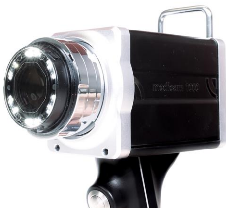
Pav. 1: „medicam 1000“ vizualizavimas su „D-Scope IV“ su nuimtu priekiniu dangteliu ir aktyviu šviesos diodų apšvietimu poliarizuotiems vaizdams gauti.
