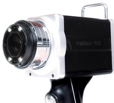
Pav. 2: „medicam 1000“ vizualizavimas su „D-Scope IV“ su nuimtu priekiniu dangteliu ir aktyviu šviesos diodų apšvietimu nepoliarizuotiems vaizdams gauti.
