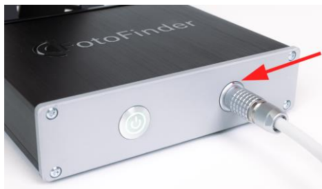
Bilde 3: Rund skyv/trekk pluggforbindelse med medicam -kabel i dokkingstasjonen
