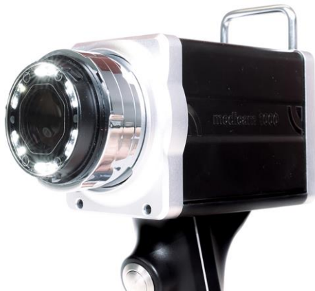
Bilde 1: Visualisering av medicam 1000 med D-Scope IV med fjernet frontdeksel og aktivt LED-lys for polariserte bilder.
