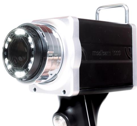
Slika 1: Vizualizacija naprave medicam 1000 z D-Scope IV z odstranjenim sprednjim pokrovčkom in aktivno LED lučko za polarizirane slike.
