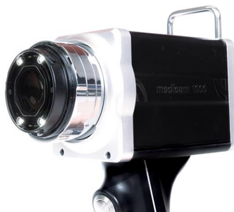
Fig. 2: Visualisering av medicam 1000 med D-Scope IV med borttaget frontlock och tänd LED-lampa för opolariserade bilder.
