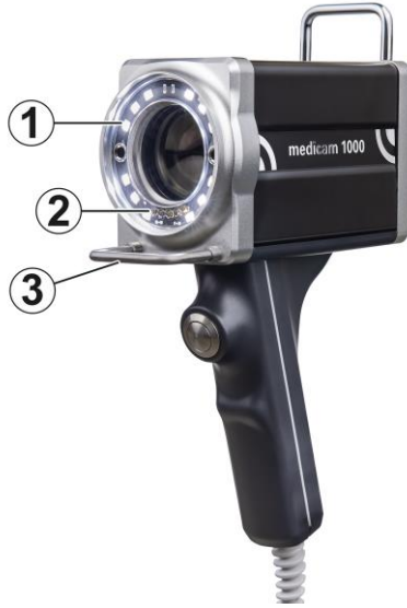
Şekil 2: Genel bakış görüntüleri için: mikroskopik lens olmadan medicam 1000
