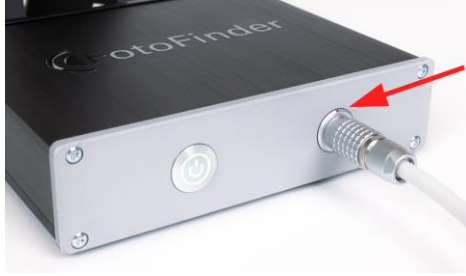
Şekil 4: Dock İstasyon üzerindeki medicam kablosu ile İtmeli-Çekmeli yuvarlak soket bağlantısı
