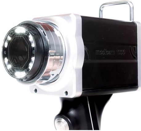
Şekil 1: Medicam 1000'in D-Scope IV ile ön başlığı çıkarılmış ve polarize görüntüler için aktif LED ışığı ile görüntüsü.
