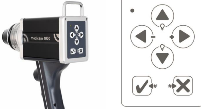
Şekil 5: medicam 1000 arka taraftan görünümü ve kontrol paneli
